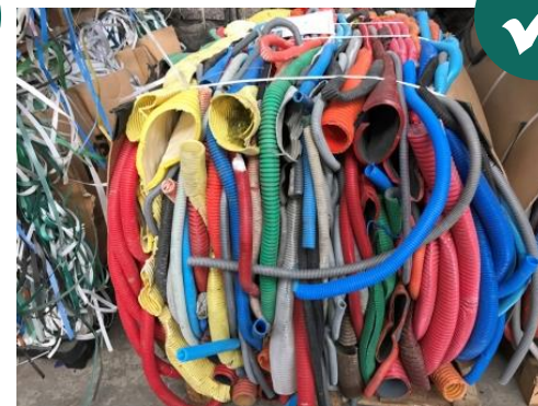
Déchets tuyaux annelés en PEHD
